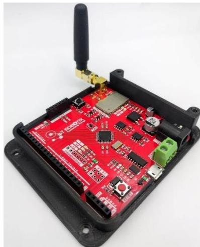
**Figura 3** Tarjeta Sigfox para la comunicación. (zh.iotshop.mx)
